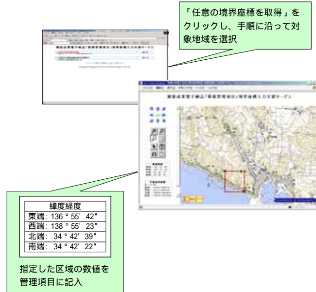
参资図 2 測量成果電子納品「業務管理項目」境界座標入力支援サービス
