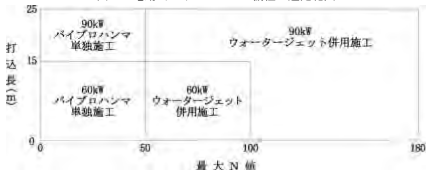
図 3-1 電動式バイブロハンマ機種の選定範囲
