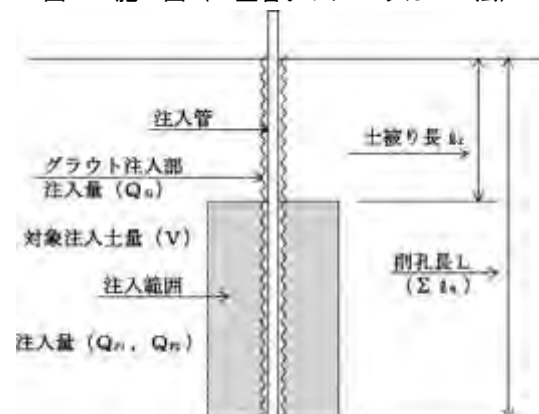
図 3.2 施工図 (二重管ダブルパッカー工法)
