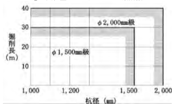
②全回転型オールケーシング掘削機
