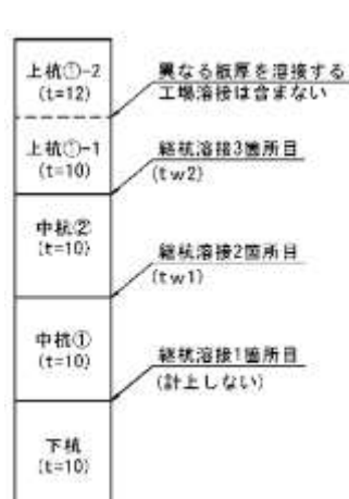
図 5-1 継杭溶接箇所 (参考図)
