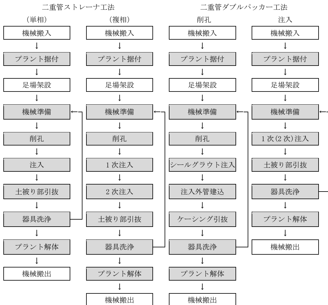
図 2.1 施工フロー図
