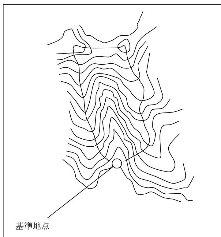
図Ⅲ- 2.18 流域面積のとり方
