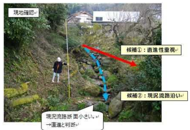
図Ⅲ- 2.27 流下方向の設定例
