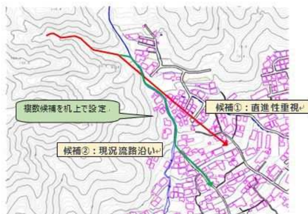
図Ⅲ- 2.27 流下方向の設定例
