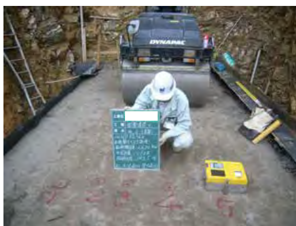
写真 3-4 RI 試験機による密度と含水比の計測事例
