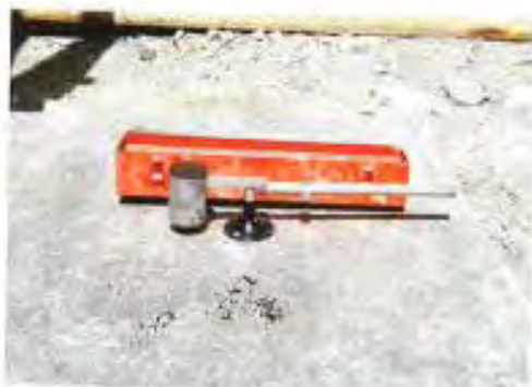
写真 3-1 セメントミルク密度測定状況
